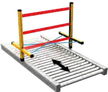
**Двустороннее приглушение с 2-мя датчиками - вход/выход.**
