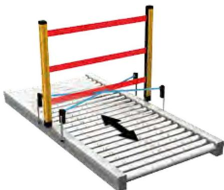
**Двустороннее приглушение с 2-мя датчиками. Вход/выход поддонов.**
