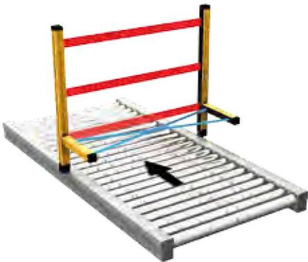
**Одностороннее приглушение с 2-мя датчиками – только выход.**
