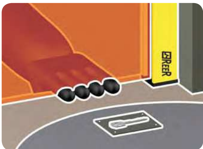
Расширение зоны защиты световой завесы за счет поддержки разрешения до самого края
