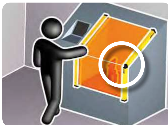
Поддерживается разрешение до 40 мм в месте стыковки 2-х зон защиты
