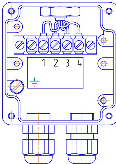
Рисунок В.1 – Клеммная коробка со снятой крышкой.
