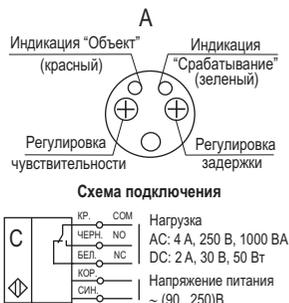
**Примечание:** Между контактами COM-NO и COM-NC отсутствуют встроенные искрогасящие цепи.
